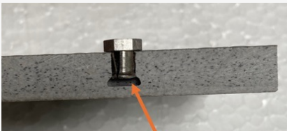
Agua penetrando en la perforación del taladro
