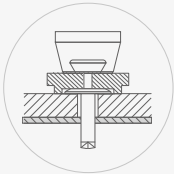
DKR. Colocación de remaches (espesor=4 y 8 mm)
