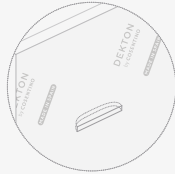
DKB. Ranura trasera intermitente CR5 (espesor=8 y 12 mm)
