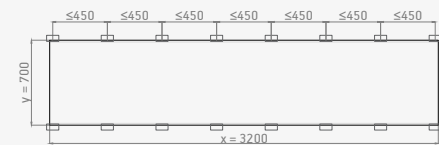
H1. Máx. Carga de diseño del viento: 1 kN/m²
